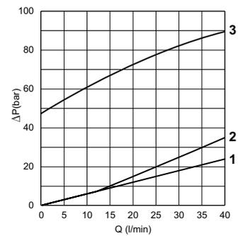
**1** = max 50 bar - **2** = max 150 bar - **3** = max 320 bar
